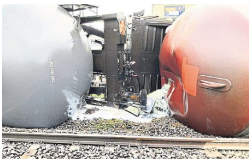
Ein Bild kurz nach der Entgleisung: Sprudelnd läuft der Dieselkraftstoff aus den leckgeschlagenen Waggons ins Gleisbett.
