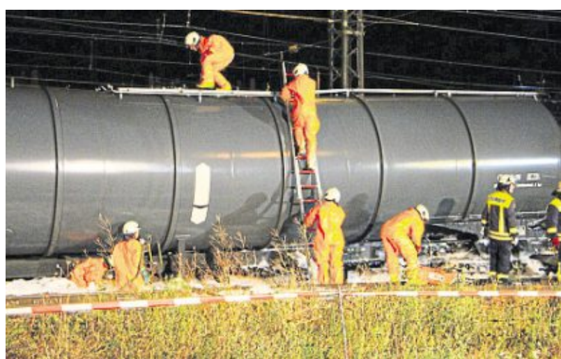
Mit Schutzanzügen ausgerüstet versuchen Feuerwehrleute in der Nacht, Löcher in den Kesselwagen abzudichten und den Diesel abzupumpen.
